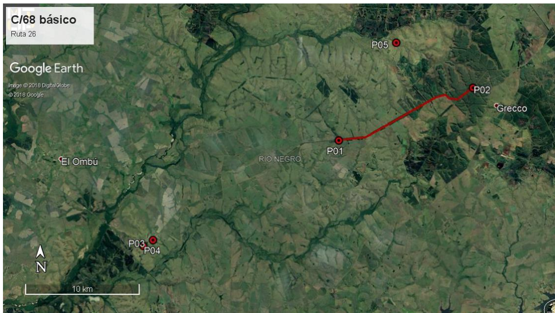
Ilustración 3 - Tramo auditado. Inicio y fin de obras: P01 y P02, Obrador principal: P03, Canteras: P04 y P05.
