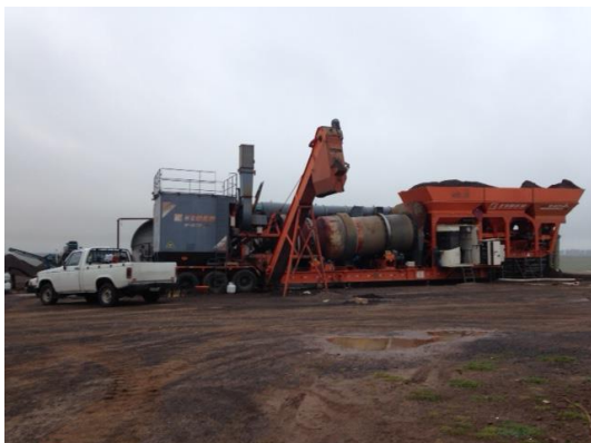
Ilustración 8 - Obrador, planta asfáltica.
