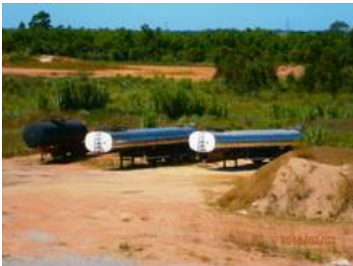
Ilustración 18- Cisternas de emulsión asfáltica
