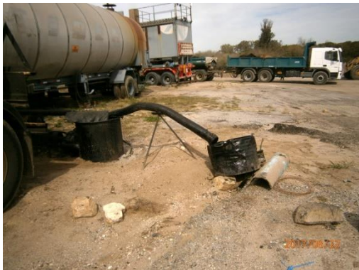
Ilustración 19 – Planta de asfalto y bandejas de contención.
