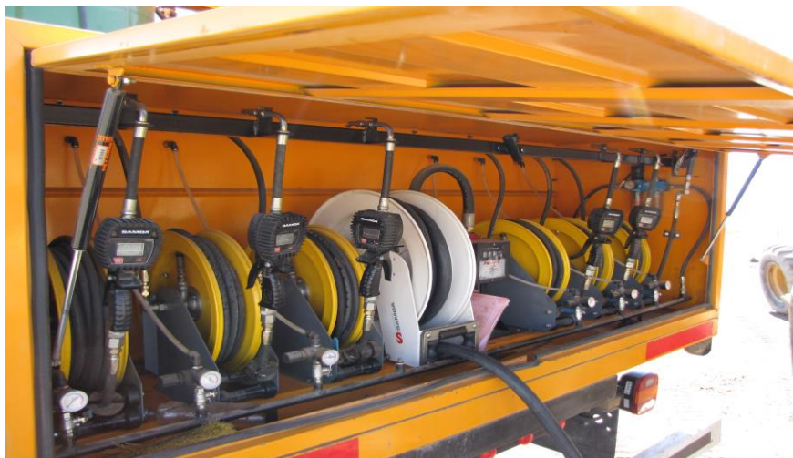
Mangueras e inyectores de suministro de combustible y lubricantes.
