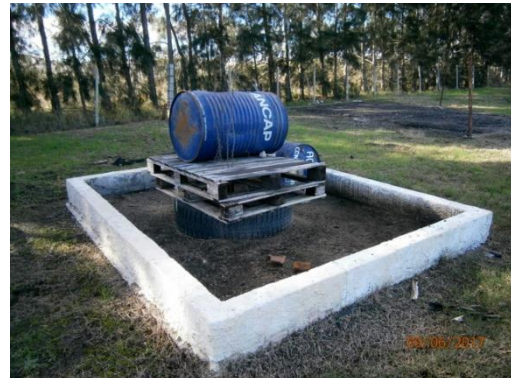
Ilustración 7-Tanques vacíos que se usaban para humedecer caja de camiones con mezcla de gasoil detergente y agua
