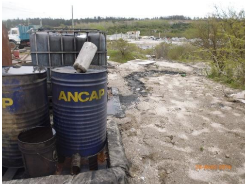
Ilustración 6 – Derrame de aceite sobre el terreno desde el sitio de contención del tanque de aceite usado.
