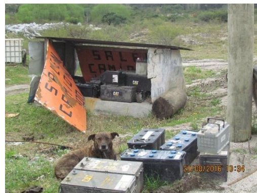
Ilustración 9 – Baterías fuera de sitio de contención. Al fondo sitio de contención.
