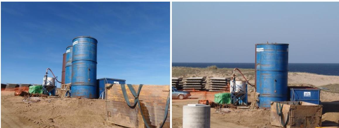
Figura 2-4 Tanques de recirculación de Bentonita
