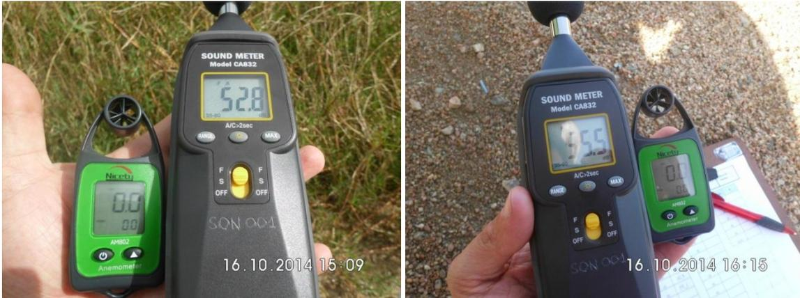
Figura 8-4 Mediciones de ruido realizadas
