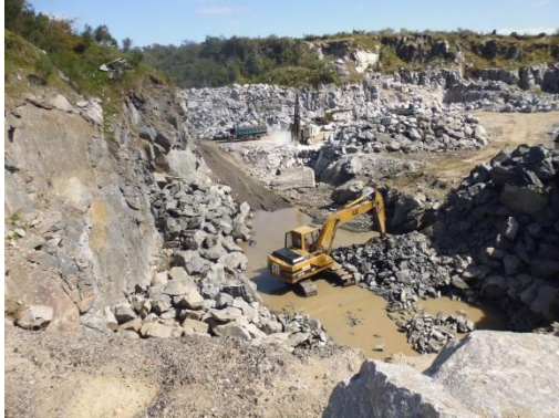
Ilustración 17 – Cantera de piedra. El riego de caminos se hace con agua de achique de la cantera.
