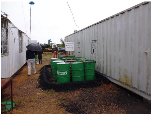
Ilustración 8 - Tanques identificados y con contención.
