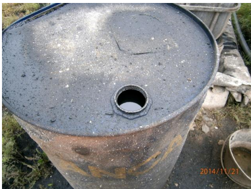
Ilustración 14-Almacenamiento de hidrocarburos de la cámara separadora
