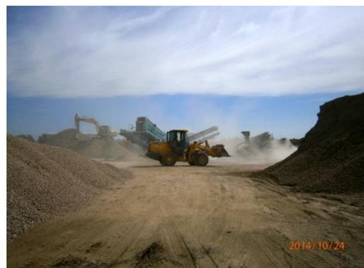
Ilustración 11 - Acopios y planta trituradora trabajando.
