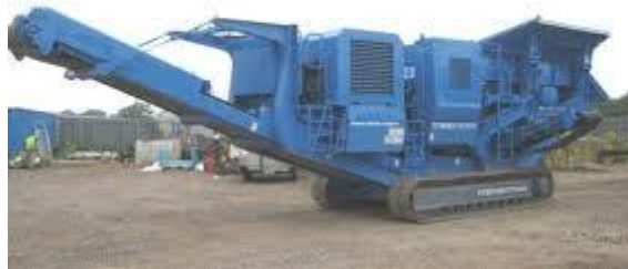
Figura 8: Vista de trituradora TEREX PEGSON 1100 x 650
