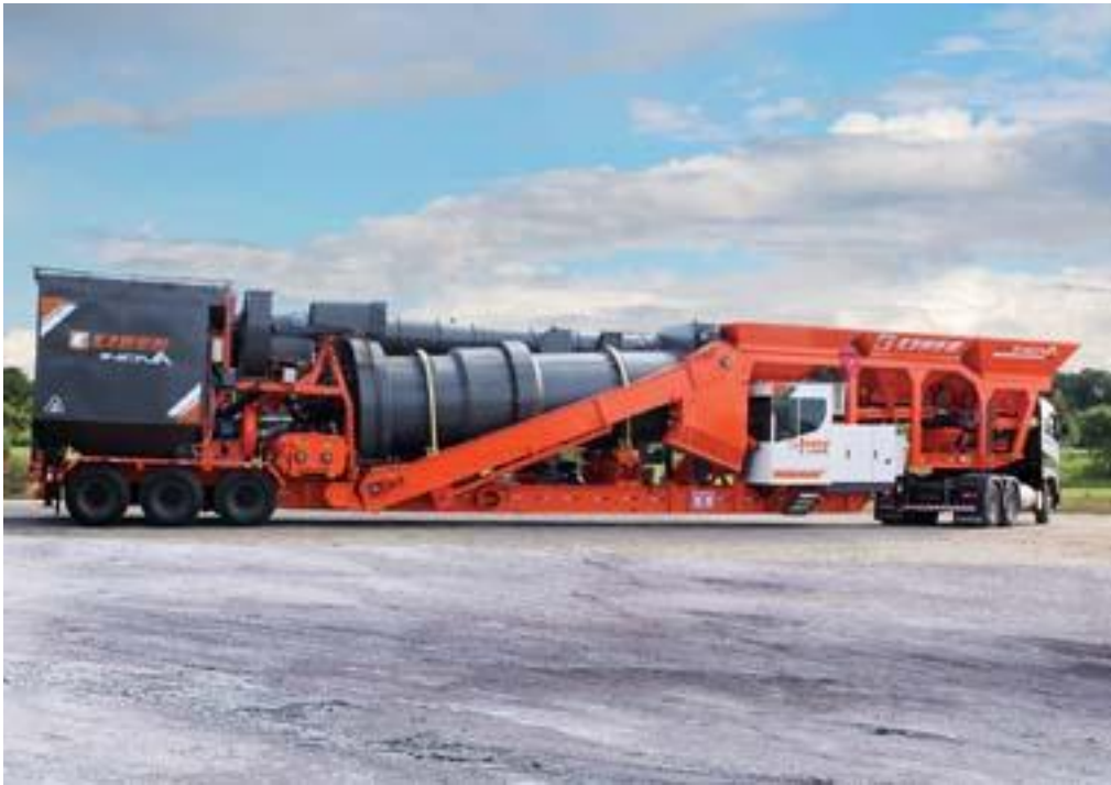
Figura 10: Transporte de planta asfáltica CIBER INOVA 1200-P1
