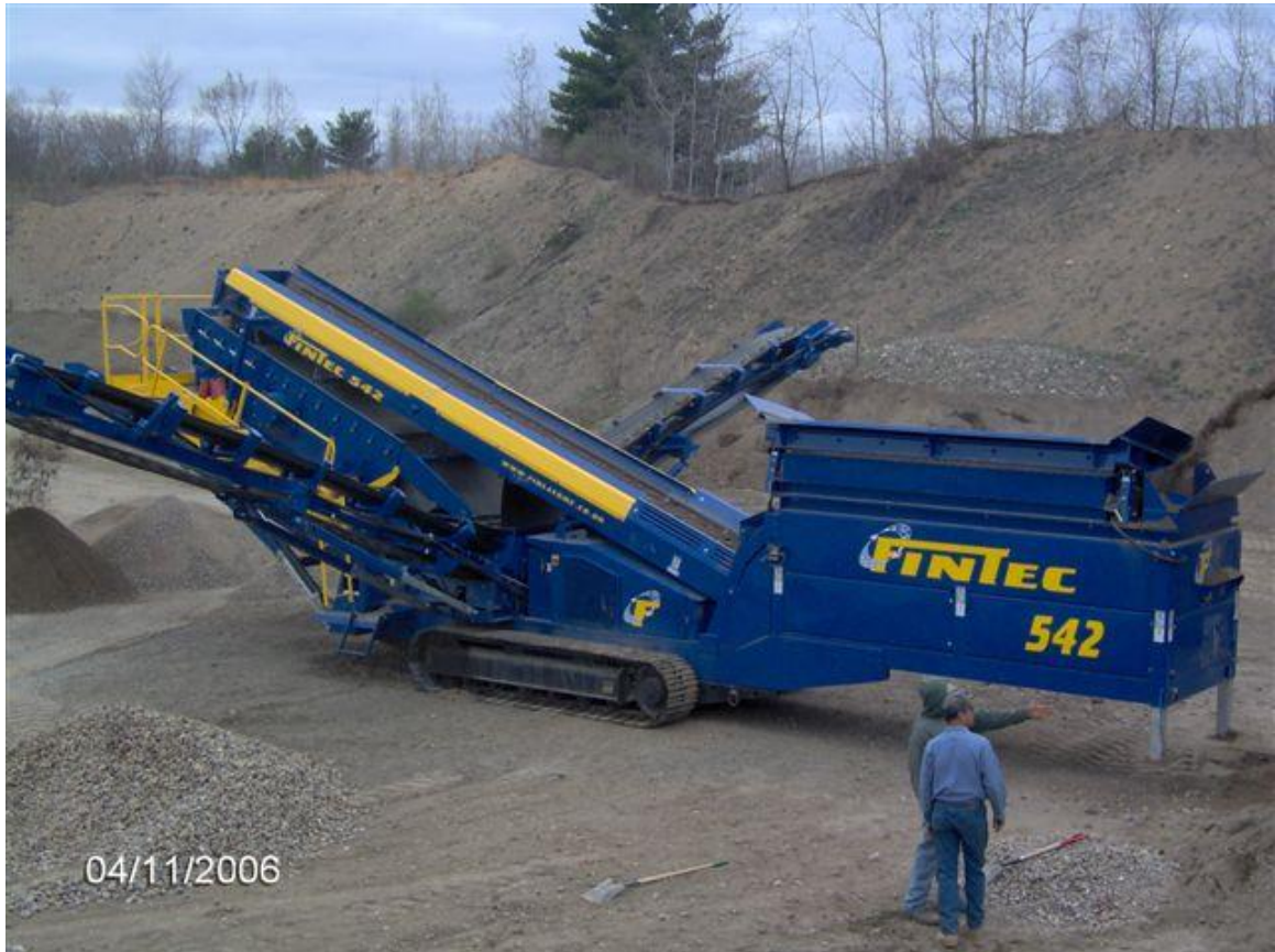
Figura 4: Vista de clasificación por zarandeo con FINTEC 542
