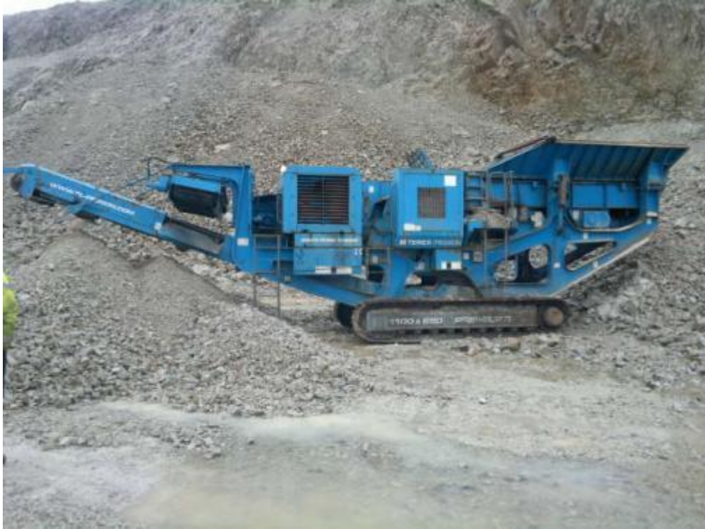
Figura 7: Vista de trituradora TEREX PEGSON 1100 x 650
