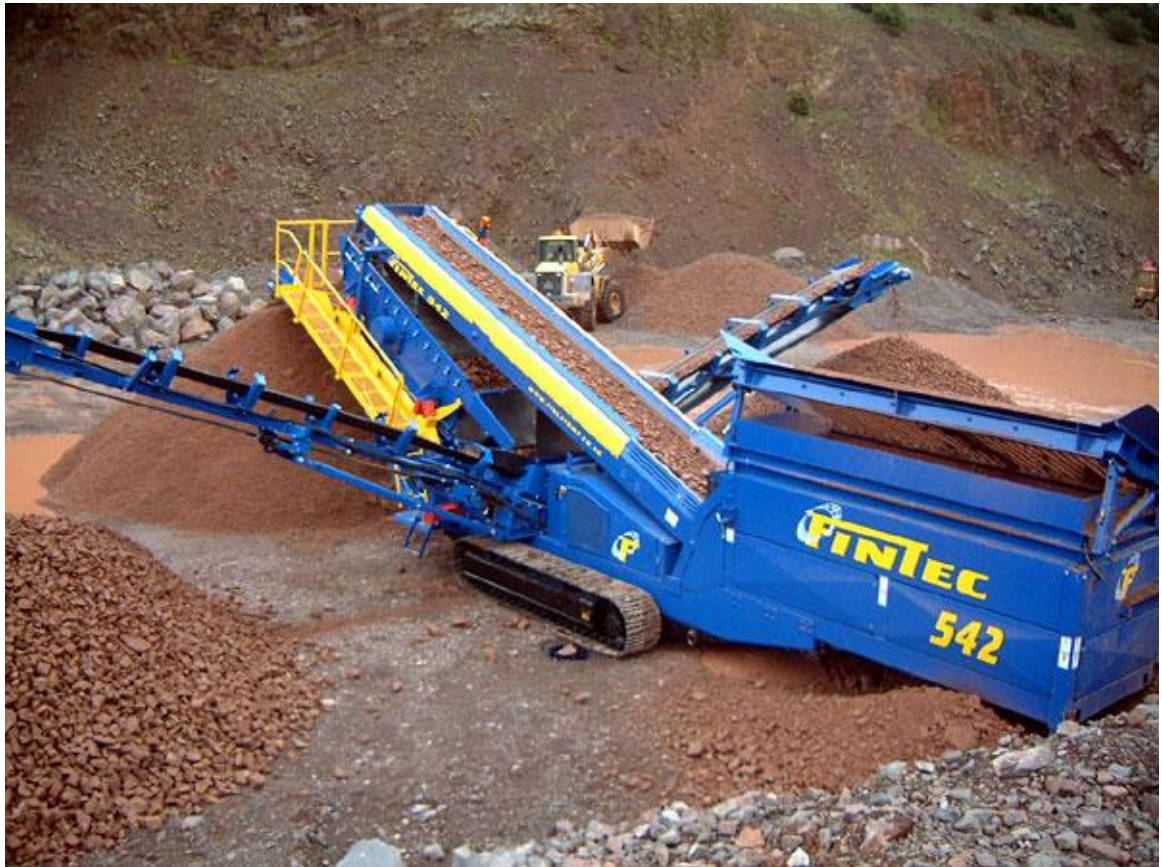
Figura 5: Vista de clasificación por zarandeo con FINTEC 542
