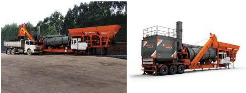
Figura 9: Vistas de planta asfáltica CIBER INOVA 1200-P1
