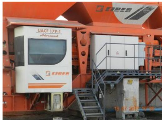
Ilustración 7: Nueva planta de producción de mezcla asfáltica con filtros de manga
