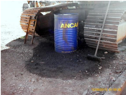
Ilustración 9 - Maquina con pérdidas de hidrocarburo
