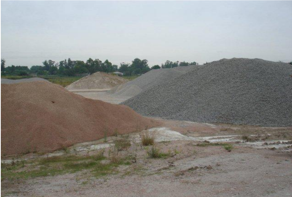
OTRA VISTA DE ACOPIOS DE AGREGADOS PARA ELABORACIÓN DE HORMIGÓN.
