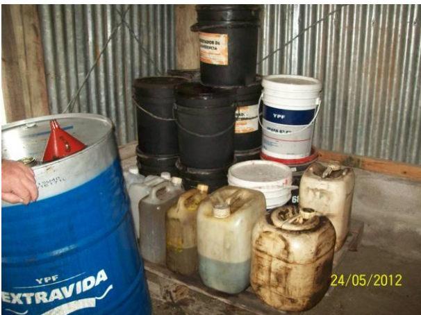
Ilustración 12 – recipientes con aceites sin identificar y sin contención
