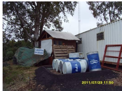
Ilustración 6: Sitio de aceites usados con dique y cubiertas en desuso con protección de la lluvia
