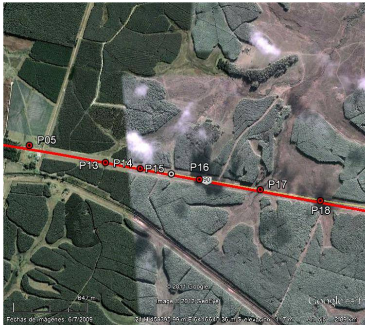
Ilustración 4: Puntos destacados, obrador y alcantarillas entre Pandule y fin del tramo del contrato
