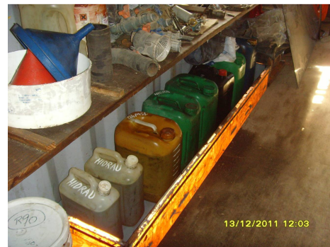
Ilustración 10: Depósito de lubricantes con protección ante derrames
