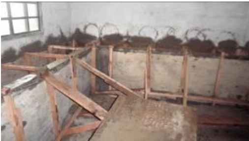
Cámara de Curado Probetas de Hormigón en Laboratorio
