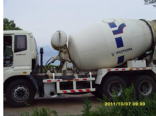
Ilustración 10: “Camión mixer” sobre plataforma de lavado
