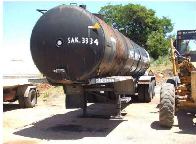
Ilustración 11 - Tanque de alquitrán sin contención
