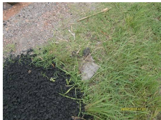
Ilustración 15 - Residuos de mezcla asfáltica con muchos días de haberse generado, con pastos nacidos dentro de los mismos
