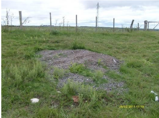
Ilustración 16 - Residuos de fresado (RAP) en la faja sin recolectar por mucho tiempo
