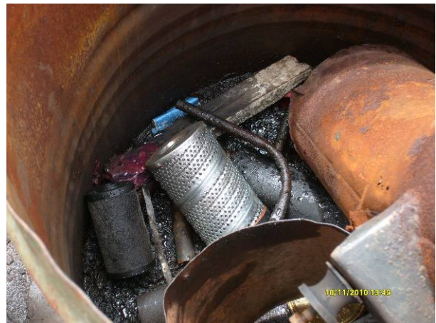
Ilustración 8 – Residuos con filtros contaminados en lugar de “Desechos metálicos”
