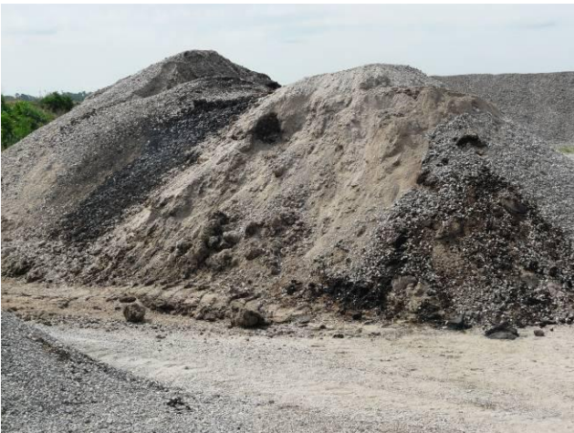
Ilustración 29 - Planta Asfáltica residuo de asfalto y combustible
