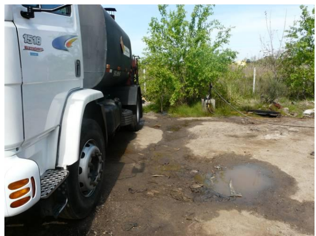
Ilustración 26 - Planta Asfáltica zona de lavado de maquinaria sin filtración
