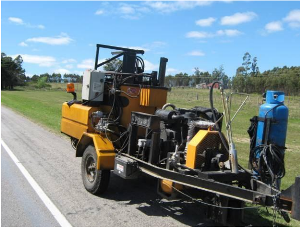
Ilustración 11 - Maquinaria utilizada en el sellado de fisuras
