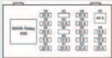
Diagrama de Fusibles en (compartimiento de motor)
